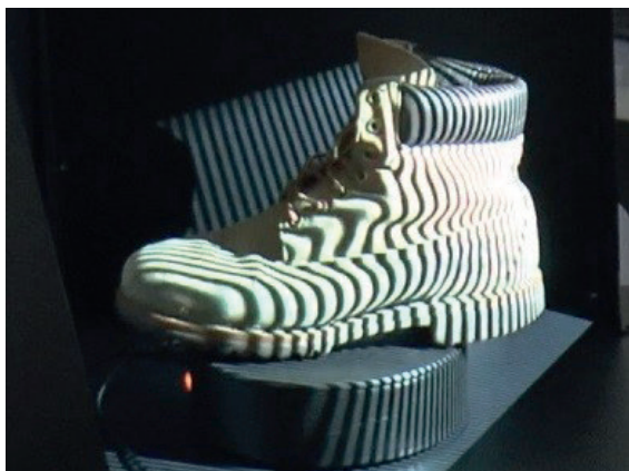
Figura 2 - Fase del processo di acquisizione della scarpa con proiezione del pattern luminoso
