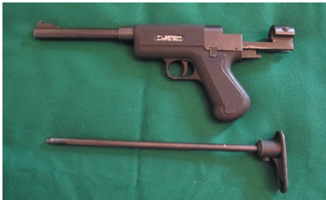
Figura 4 – Pistola-fucile monocolpo costruita negli anni '60 ca. dai F.lli Serena di Brescia in cal. 28-32-36 e 9 mm Flobert, dotata anche di un calciolo smontabile in ferro per facilitarne l'uso, la stabilità e la precisione.
